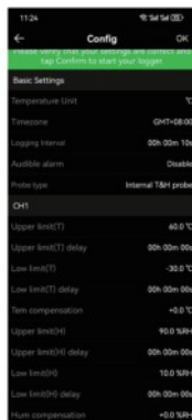
⑥ ustaw górną i dolną granicę alarmu oraz opóźnienie alarmu
